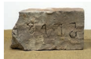
SYGNATURA „БГ 1840”, SKOPIOWANA PRZEZ ROBOTNIKA W ODBICIU LUSTRZANYM, JAK BYŁO NA DREWNIANYM STEMPLU
