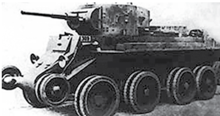
Czołg BT bez gąsienic, gotowy do jazdy na kołach. Wszystkie koła mocno oparte o ziemię. Gąsienic nie ma. BT zostawiał gąsienice licząc na to, że mu je na nowe miejsce dowiozą. A jak nie dowieźli? – To była katastrofa!
