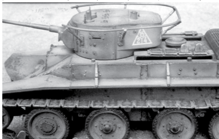
Czołg BT5. Widać okalającą wieżę czołgu potężną antenę radiową
